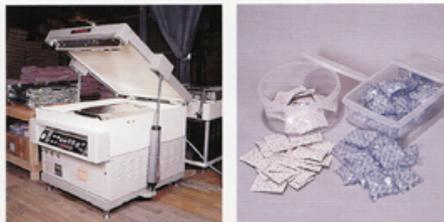
パック事前処理を終えた製品はナイロンもしくはアルミ蒸着特殊多層フィルムに入れ、迅速に1/3までチャンパー圧縮され真空包装処理の後、再プレスしますので平面状(しわ取り)になります。(保管状況に応じて、積出量の脱酸素剤、乾燥剤の封入及びチツソガスの封入)
